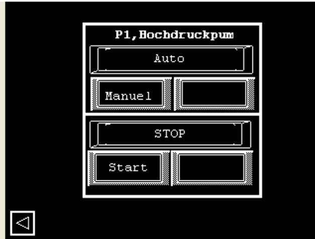
Manuell ist durch drücken zu aktivieren, bevor eine Bedienung möglich ist. Die Anlage muss sich im Stop-Zustand befinden, um die Knöpfe bedienen zu können. Wenn man zurück auf Betriebsstellung wechselt, schalten alle Komponenten auf Auto zurück. Bei Manuell Bedienung muss die Anlage im Stop-Zustand sein.
