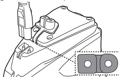
3. Conecte o adaptador externo à fonte de alimentação. A luz indicadora no adaptador externo fica vermelha assim que o carregamento começa. A luz indicadora no adaptador externo ficará verde quando o robô está carregado.
