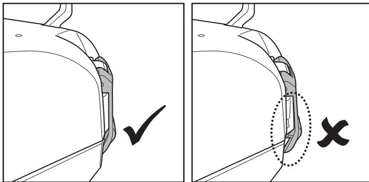
**VINKKI:** Ennen kuin laitat robotin uudelleen altaaseen, pidä kiinni rungon yläkannen siivistä ja heiluta robottia hieman varmistaaksesi, että yläkansi on tukevasti rungossa kiinni.
