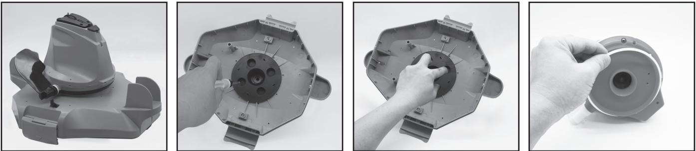
2. Use el destornillador para desatornillar los 4 pernos situados en la parte inferior del cabezal para liberar la placa inferior. Desatornille todos los pernos de la base, tal como aparece en la imagen. Retire el propulsor, tire de la base y sáquela para dejar el cabezal al descubierto.
