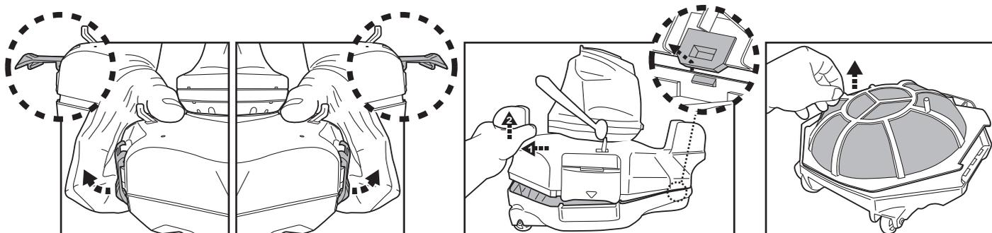
2. Irrota suodatinsuojus ja poista roskat säiliöstä. On suositeltavaa puhdistaa suodatinsuojus roiskuttamalla siihen vettä. Jos harjaus katsotaan tarpeelliseksi, käytä vain pehmeää harjaa huolellisesti ja varovasti vaurioiden välttämiseksi.
