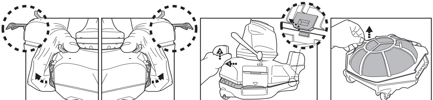
2. Maak het filterdeksel los en verwijder het vuil uit het compartiment. Het wordt aanbevolen om het filterdeksel schoon te maken met spatwater. Als borstelen noodzakelijk wordt geacht, gebruik dan alleen een zachte borstel om het filter voorzichtig te reinigen om beschadiging te voorkomen.
