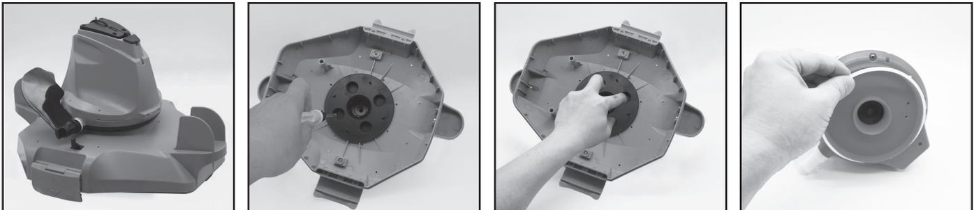
2. Använd skruvmejseln för att lossa de 4 skruvarna på undersidan av huvudet för att ta av den undre plattan först. Lossa sedan alla skruvarna vid basen enligt bildanvisningarna. Plocka bort fläkthjulet och band upp basen för att frilägga huvudet inuti.
