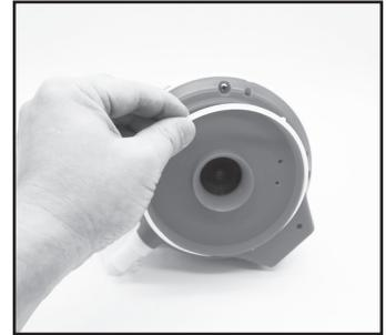
2. Lösen Sie mit dem Schraubenzieher die 4 Schrauben an der Unterseite des Schwenkkopfs, um die Platte zu entfernen. Mit dem Schraubenzieher alle Schrauben wie gezeigt lösen. Den Laufrad entfernen und anschließend nach oben ziehen und entfernen, so dass der Kopf zugänglich ist.
