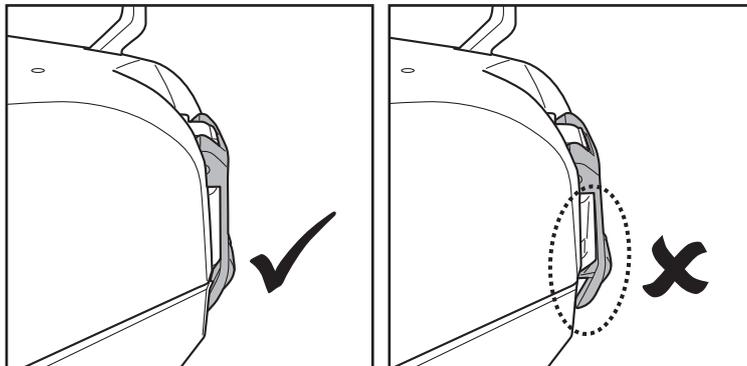
**SUGGERIMENTI:** Prima di ricollocare il robot nella piscina, afferrare le ali dal coperchio superiore del corpo e scuotere leggermente il robot, per garantire che il coperchio superiore sia fissato alla base.
