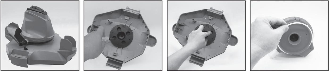
2. Utiliser le tournevis pour dévisser les 4 vis situées en dessous de la tête pivotante pour retirer la plaque inférieure. Utiliser le tournevis pour dévisser toutes les vis de la base comme indiqué. Retirer la turbine, puis soulever la base et la retirer pour exposer la partie intérieure.
