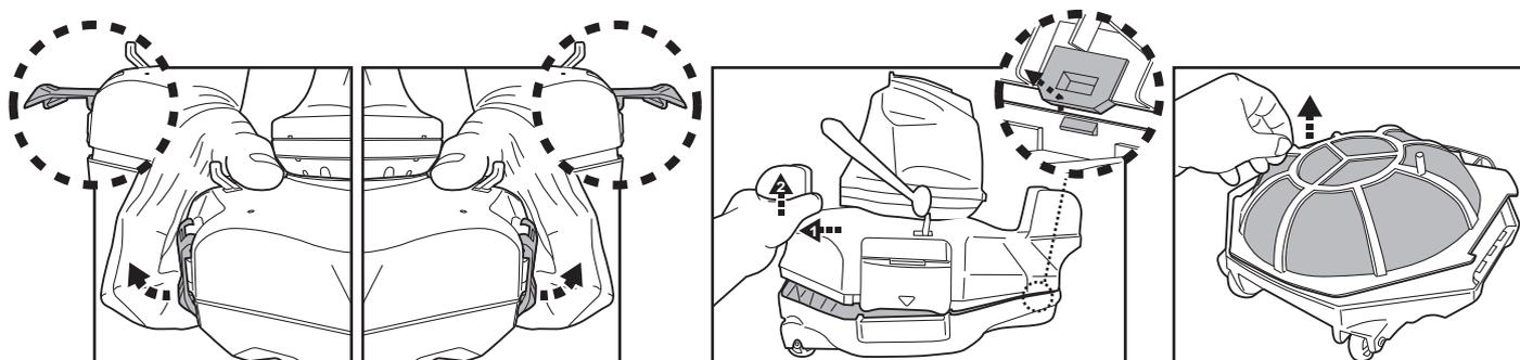
2. Lossa filterkåpan och töm behållaren på skräp. Vi rekommenderar att du rengör filterkåpan nätt med rinnande vatten. Vid behov kan du även rengöra nätet försiktigt med en mjuk borste för att undvika att skada det.
