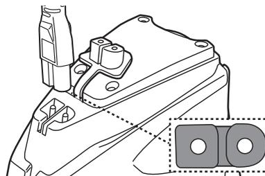
3. Collegare l'adattatore esterno alla fonte di alimentazione. L'indicatore luminoso sull'adattatore esterno diventa rosso una volta iniziata la ricarica. L'indicatore luminoso sull'adattatore esterno diventerà verde quando il robot è carico.
