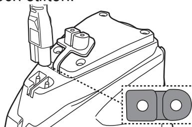
3. Anslut den externa adaptern till strömkällan. Indikatorlampan på den externa adaptern lyser rött när laddningen påbörjats. Indikatorlampan på den externa adaptern kommer att lysa grönt när roboten är fulladdad.
