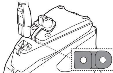
3. Steek de externe adapter in een stopcontact. Het indicatielampje op de externe adapter wordt rood als het laden begint. Het indicatielampje op de externe adapter wordt groen wanneer de robot is opgeladen.
