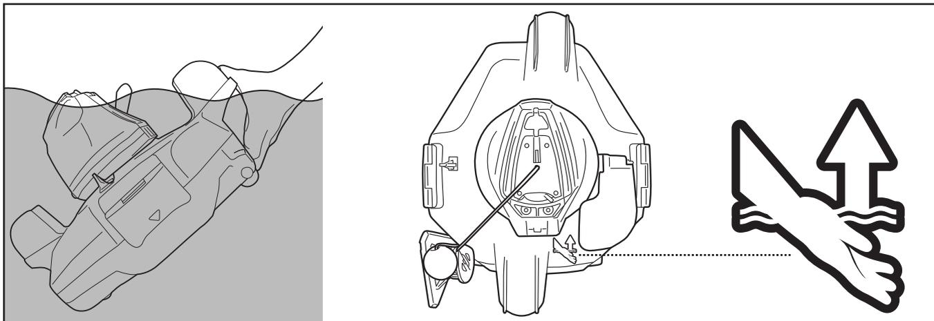
5. Liu'uta virtakytkin pois PÄÄLTÄ -asentoon. Huuhtele robotti puhtaalla vedellä jokaisen käytön jälkeen. ÄLÄ käytä mitään pesuainetta.
