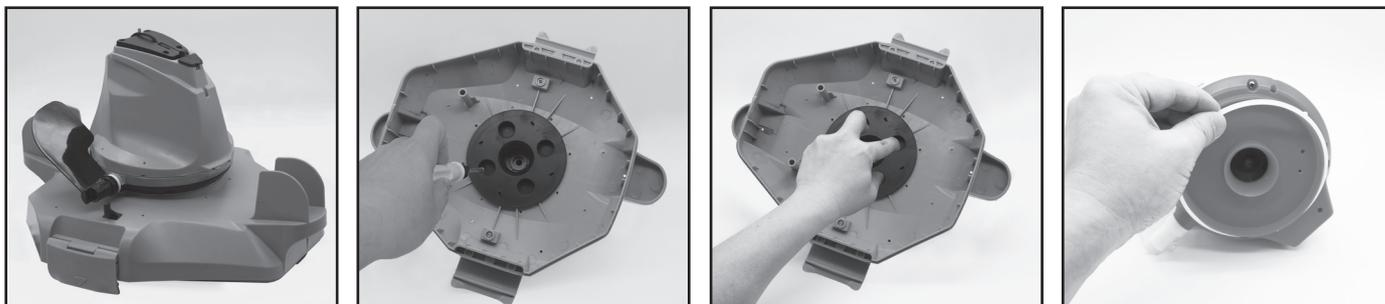
2. Bruk skrutrekkeren til å fjerne de fire skruene på bunnen av hodet for å fjerne bunnlåseplaten først. Fjern deretter alle skruene fra sokkelen som vist. Fjern løpehjulet og press opp sokkelen for å avdekke hodet inni.
