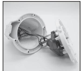
3. Akku herausnehmen, so dass PCBA zugänglich ist. Um die Anschlussdrähte vom Akku zu lösen, auf den Clip am Stecker drücken und dann herausziehen. **HINWEIS:** Umwickeln Sie den Stecker sofort mit Isolierband, um einen Kurzschluss durch einen Kontakt der beiden Drahtenden zu vermeiden.
