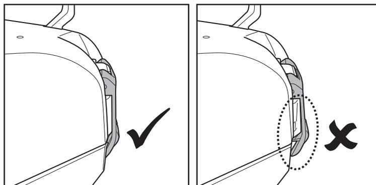
**TIPS:** Voordat u de robot opnieuw in het zwembad plaatst, houdt u de vleugels op het bovendeksel van de behuizing vast om de robot een beetje te laten zwaaien, zodat het bovendeksel aan de basis wordt bevestigd.
