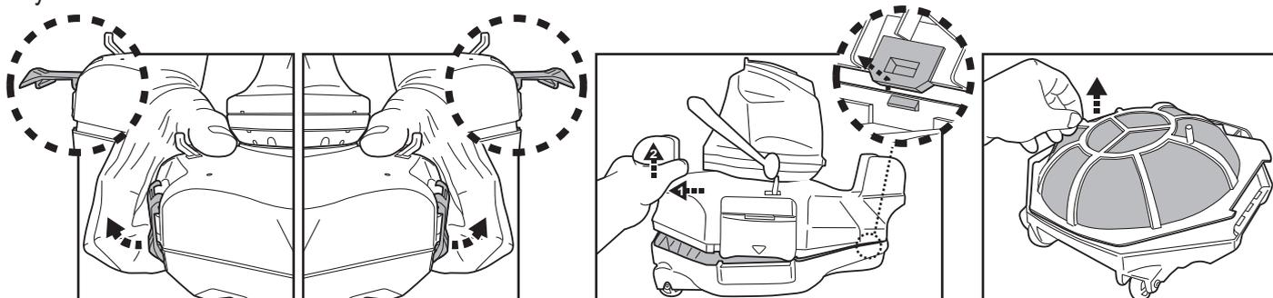
2. Vyndejte kryt filtru a odstraňte nečistoty z prostoru. Doporučujeme vyčistit síťku filtru proudem vody. Pokud považujete za nutné síťku kartáčovat, čistěte ji jemně, pouze měkkým kartáčem, a to tak, aby nedošlo k jejímu poškození.
