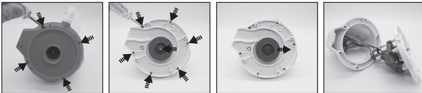
3. Retire o pack da bateria para exportar o PCBA. Para retirar o cabo de ligação da bateria, prima o clipe do conector para o puxar para fora. **NOTA:** Enrole o conector imediatamente com fita isoladora de modo a evitar qualquer curto-circuito causado pelo contacto de ambos os terminais de cabo.
