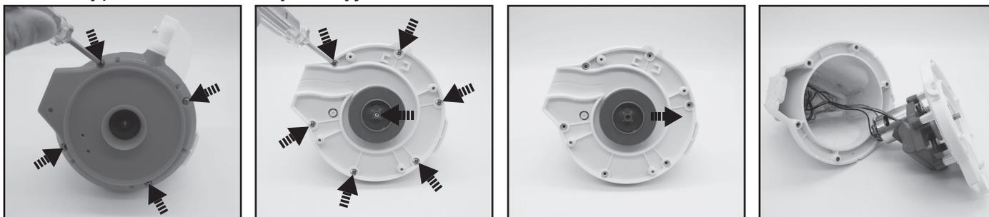
3. Vyjměte baterii, abyste odkryli desku plošných spojů. Chcete-li odpojit připojovací vodič baterie, zatlačte na sponu konektoru a vytáhněte jej. **POZNÁMKA:** Konektor okamžitě obalte izolační páskou, aby nedošlo ke zkratu způsobenému kontaktem obou sverek vodiče.
