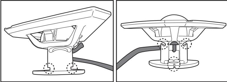
O comprimento correto do cabo deverá ser equivalente à distância entre o topo do robô e o nível de água. **NOTA:** O comprimento em excesso poderá dobrar o cabo e afetar o desempenho em resultado disso.
