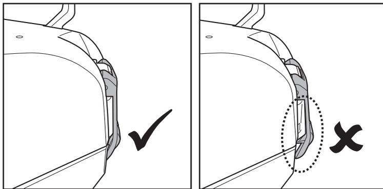
**TIPS:** Ta tag i vingarna på täckkåpan och gunga roboten försiktigt innan du sänker ned den i poolen igen, för att säkerställa att täckkåpan sitter fast i basen.
