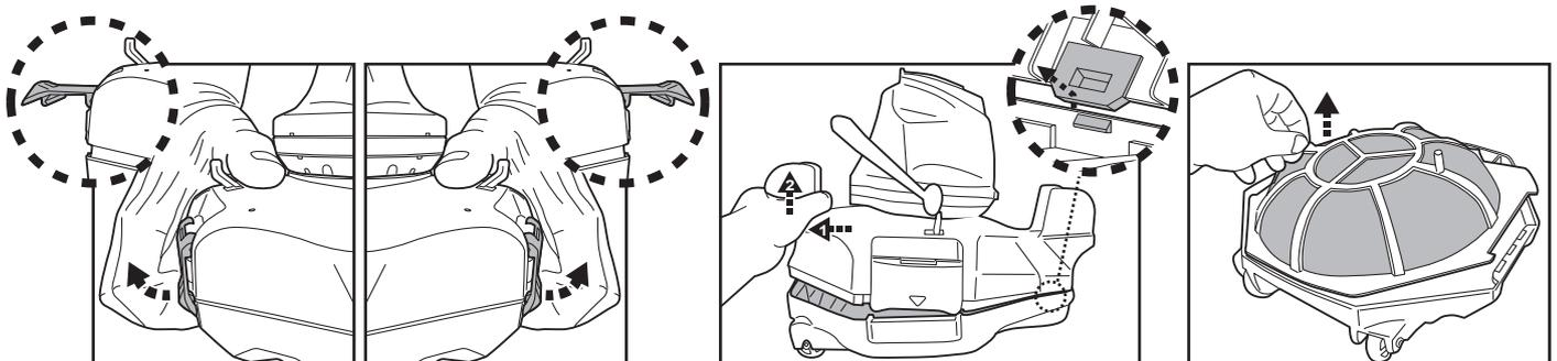
2. Bauen Sie die Filterabdeckung heraus und entfernen Sie den Schmutz aus dem Behälter. Es wird empfohlen, das Filterabdecksieb mit laufendem Wasser zu reinigen. Sollte das Sieb gebürstet werden müssen, verwenden Sie ausschließlich eine weiche Bürste und reinigen Sie es vorsichtig und sanft, um es nicht zu beschädigen.
