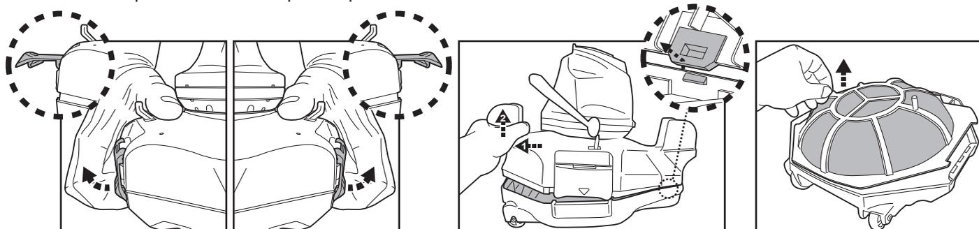
2. Retirer le couvercle filtrant puis nettoyer le compartiment à débris. Il est recommandé de nettoyer le couvercle filtrant à l'aide d'un jet d'eau. Si un brossage est jugé nécessaire, utiliser seulement une brosse douce pour nettoyer soigneusement et délicatement. N'appliquer aucune pression sur le filtre.
