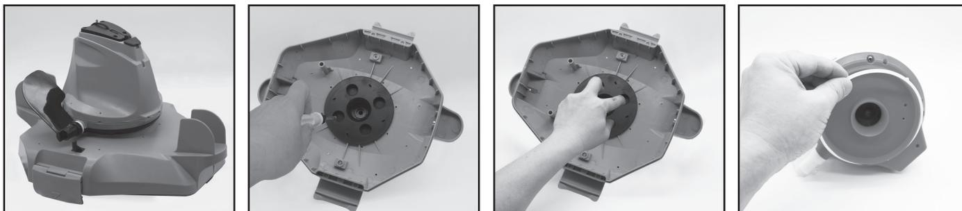
2. Pomocí šroubováku odšroubujte 4 šrouby umístěné ve spodní části hlavy, abyste nejprve uvolnili spodní desku. Poté odšroubujte všechny šrouby na základně, jak je znázorněno níže. Vyjměte rotor a vypáčením základny odkryjte vnitřek.
