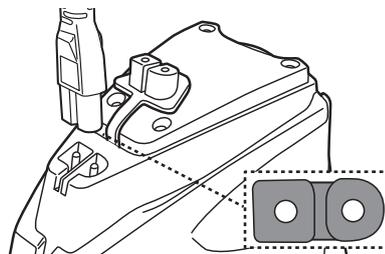
3. Connecter le transformateur à la source d'alimentation. Le voyant de l'adaptateur externe devient rouge une fois que la charge commence. Le voyant de l'adaptateur externe devient vert lorsque le robot est chargé.
