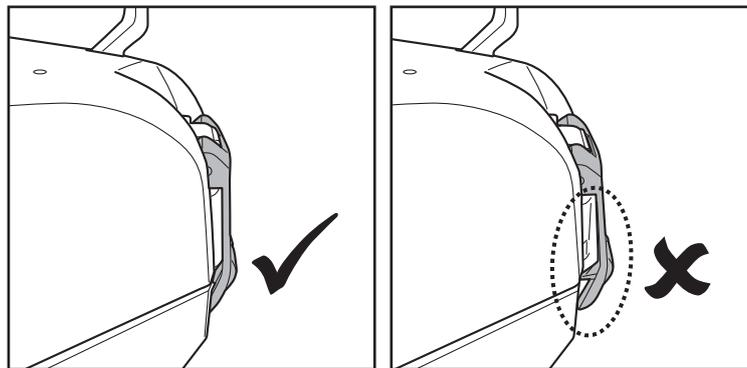
**TIPY:** Před opětovným umístěním vysavače do bazénu přidrže křídla na horním krytu těla, aby se robot mírně pohnul, což zajistí připevnění horního krytu k základně.
