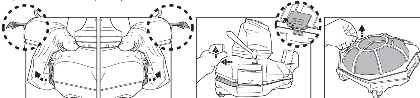
2. Suelte la tapa del filtro y vacíe la suciedad del compartimento. Se recomienda limpiar la malla de la cubierta del filtro con agua. Si requieren cepillado, utilice un cepillo suave y límpielas con delicadeza para evitar deteriorarlas.
