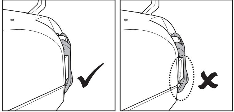
**CONSEJO:** Antes de volver a usar el robot, sostenga los clips laterales de la cubierta para que el robot oscile ligeramente, para asegurarse de que la cubierta esté fijada a la base.
