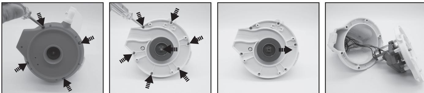
3. Извлеките аккумуляторную батарею, чтобы открыть печатную плату. Чтобы отсоединить провод подключения аккумулятора, нажмите на зажим разъема, чтобы вытащить его.
