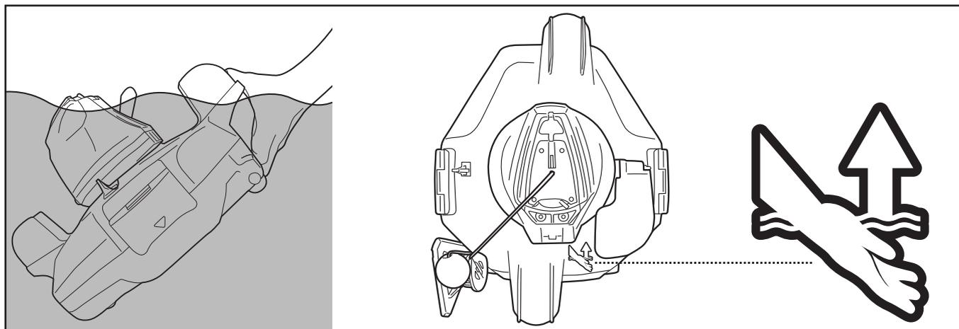
5. Desligue o interruptor para OFF. Lave o robô com água fresca a cada utilização. **NÃO** utilize qualquer detergente.
