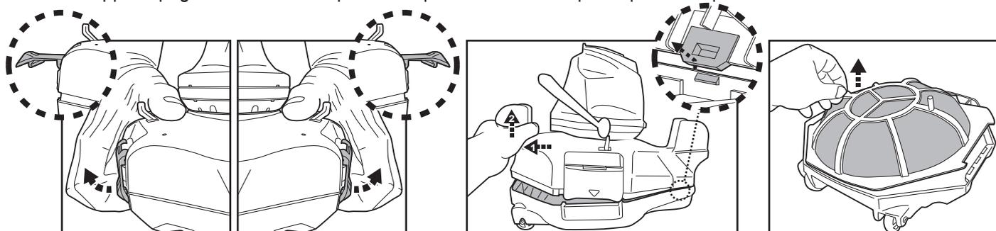
2. Rimuovere il coperchio del filtro e rimuovere i detriti dal compartimento. Si raccomanda di pulire il coperchio del filtro con acqua corrente. Se è necessario spazzolare, utilizzare esclusivamente una spazzola morbida per pulirlo delicatamente evitando di danneggiarlo.
