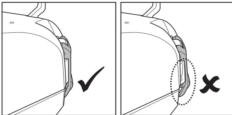
**DICAS:** Antes de transferir o robô para a piscina, segure as asas da tampa superior do corpo para oscilar o robô ligeiramente, para assegurar que a tampa superior fica segura à base.
