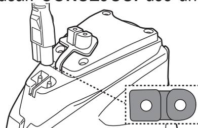
3. Conecte el adaptador externo a la fuente de alimentación. El indicador LED del adaptador externo se vuelve rojo después de que comienza la carga. El indicador LED del adaptador externo se vuelve verde cuando el robot está cargado.
