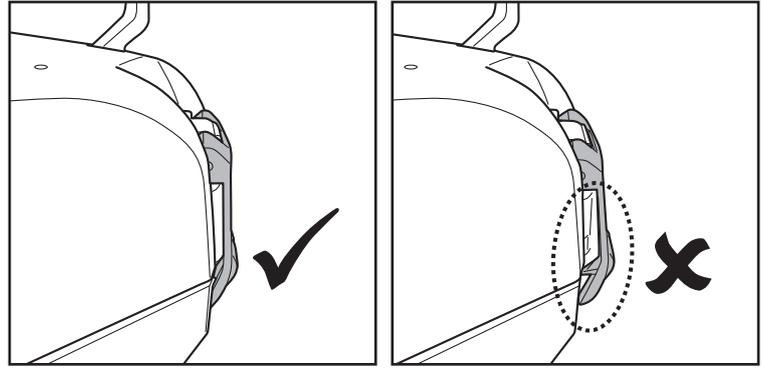
**TIPP:** Halten Sie den Roboter vor dem Wiedereinsetzen in das Schwimmbecken an den Flügeln der oberen Abdeckung des Gehäuses fest, um den Roboter leicht zu schwenken und sicherzustellen, dass die obere Abdeckung am Boden befestigt ist.
