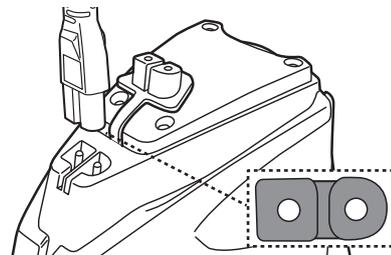
3. Připojte externí adaptér ke zdroji napájení. Jakmile se začne robot nabíjet, rozsvítí se kontrolka na externím kabelu zeleně.
