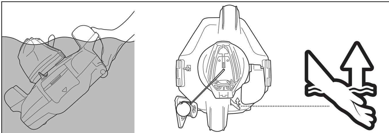
5. Vypněte robota. Po každém použití opláchněte robota čistou vodou. **NEPOUŽÍVEJTE** žádný prací prostředek.
