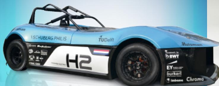
Der mit Wasserstoff betriebene FORZE VI – das für „Formula Zero“ – Rennsport ohne Emissionen steht, wurde von einem Forscherteam der Technischen Universität Delft entwickelt und erreicht eine Spitzengeschwindigkeit von 220km/h. Der 880kg schwere Wagen verfügt über ein Brennstoffzellensystem mit einer BWT FUMATECH Hochleistungsmembran, die eine Schlüsselfunktion der vollkommen emissionsfreien Energieumwandlung darstellt.
