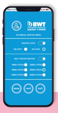
Alle Settings im Uberblick wie z.B. eine stufenlos einstellbare Verschneidung für eine zielgenaue, bedarfsgerechte Demineralisierung
