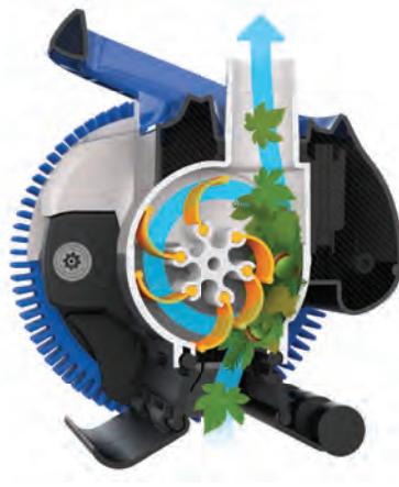
V Flex® turbine à pales mobiles pour capture de gros débris
