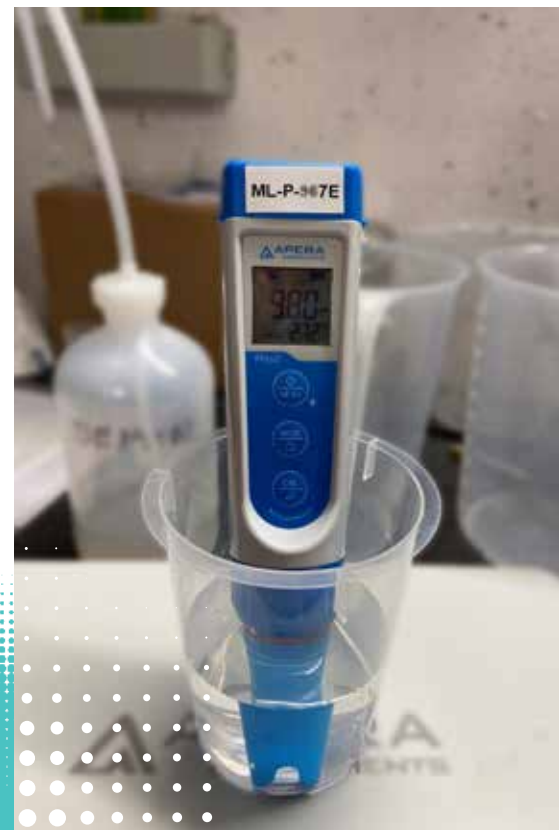
Mesure du pH avec des bandes test et/ou un pH-mètre (© Aqualisys)
