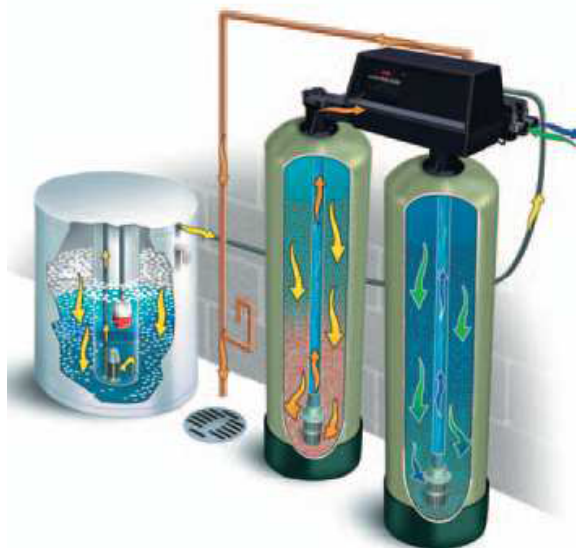
2. ábra – kétoszlopos készülék működési vázlatja
