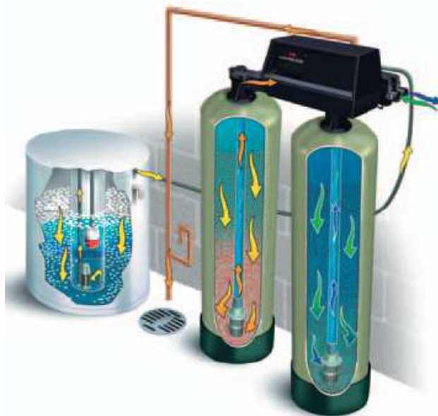
2. ábra – kétoszlopos készülék működési vázlat
