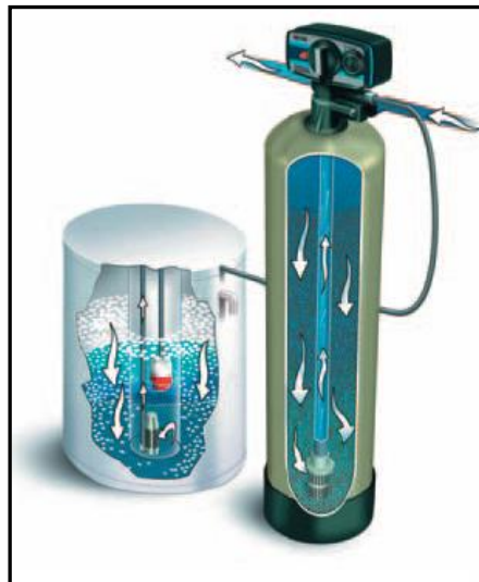
2. ábra – egyoszlopos készülék működési vázlata
