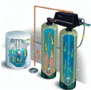
2. ábra Kétoszlopos készülék működési vázlatja
