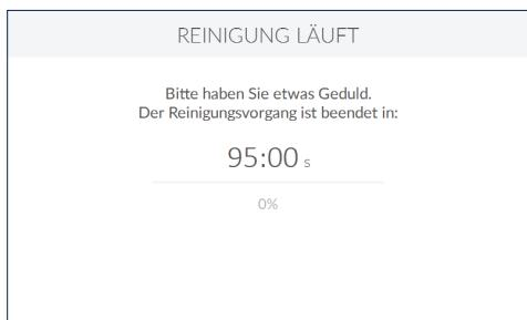
Die Reinigung startet und die verbleibende Zeit bis zum Ende des Spülvorgangs wird angezeigt.
