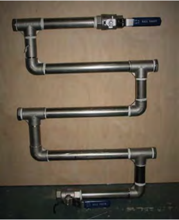
Roestvrijstalen corrosierek, met isolatiekleppen
